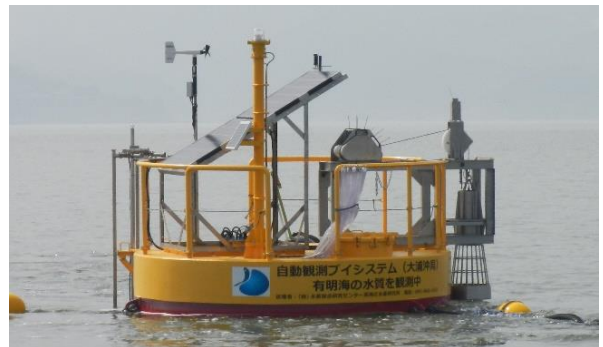
写真2. 有明海湾奥部に設置し管理・運用中の自動昇降式水質観測ブイ
